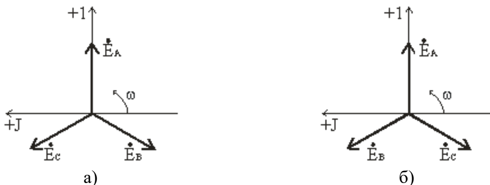
2-сурет. Үшфазалы тізбектің векторлық диаграммасы
